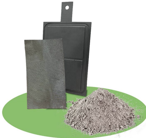
Abb1: Komponenten-Bestandteile für die wiederaufladbare Zink-Luft-Batterie
