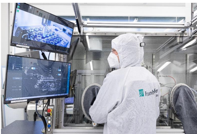
Elektrolytbefüllung von 21700 Rundzellen (© Fraunhofer IPA/Foto: Rainer Bez)
